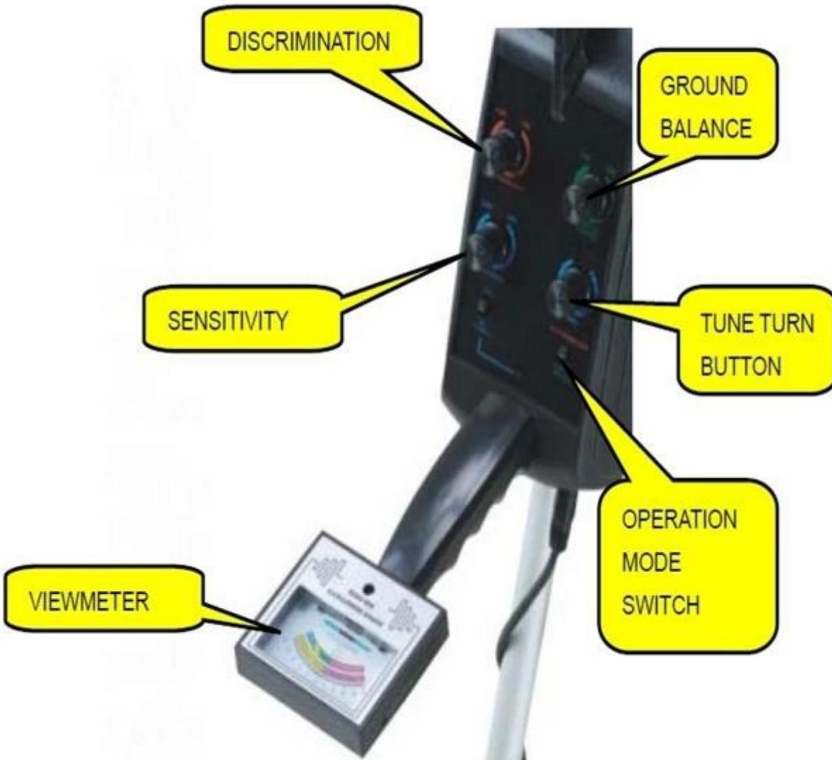
1. 打开电源开关，将灵敏度调到最大，将频率调到12.5kHz，将深度调到最大，将音量调到最大，将模式调到DISC，将识别调到ALL，将平衡调到平衡，将探测线圈埋入地下，按下探测按钮，听到蜂鸣声，表示有金属物体。
